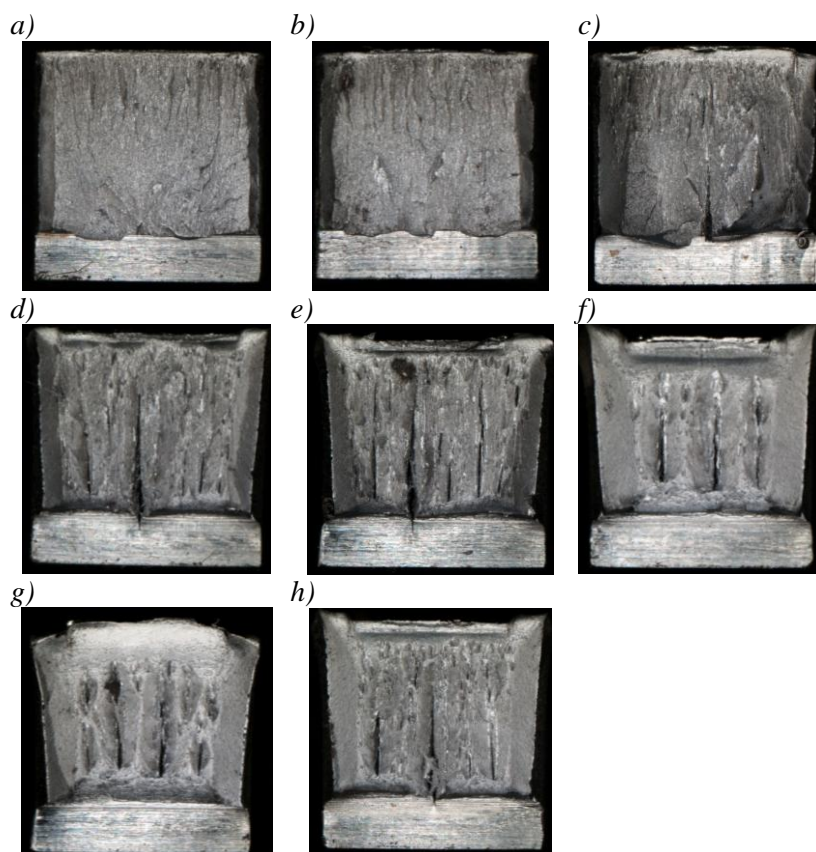
Rys.6. Makroskopowy obraz przelomów złamanych próbek stali Domex 700MC w temperaturze: a) -100^{\circ}\text{C} , b) -60^{\circ}\text{C} , c) -30^{\circ}\text{C} , d) 0^{\circ}\text{C} , e) +10^{\circ}\text{C} , f) +20^{\circ}\text{C} , g) +50^{\circ}\text{C} , h) +100^{\circ}\text{C}
